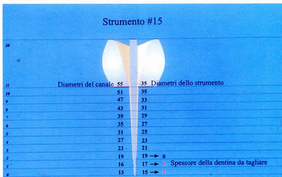
Fig. 2 - Modello grafico: sulla sinistra sono scritti i diametri canalari ad ogni millimetro della lunghezza canalare; i corrispondenti diametri dello strumento sono indicati a destra insieme alla differenza tra i diametri del canale e dello strumento, che indicano lo spessore di dentina che deve essere tagliata perché lo strumento possa avanzare di un millimetro.
