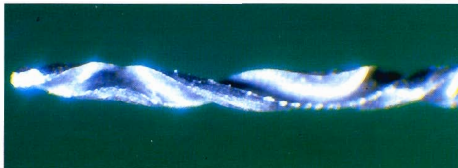
Fig. 13 - Strumento sottoposto a stress torsionale che ne ha determinato la deformazione.
